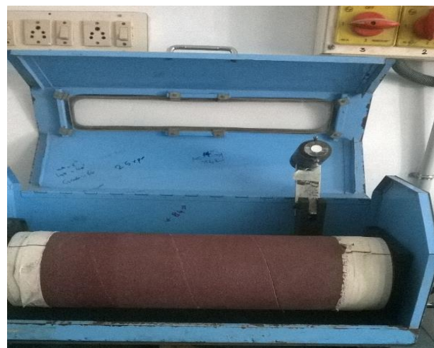
Fig. 4. Din type abrasion tester.
