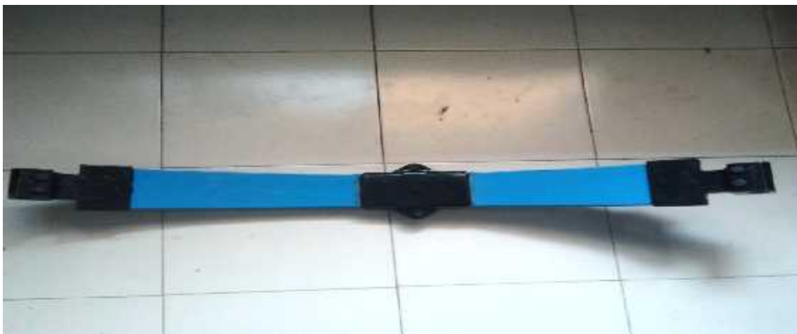
Fig. 3 Actual composite mono leaf
