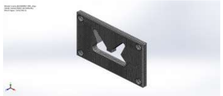
Fig 8. Meshing Of Die
