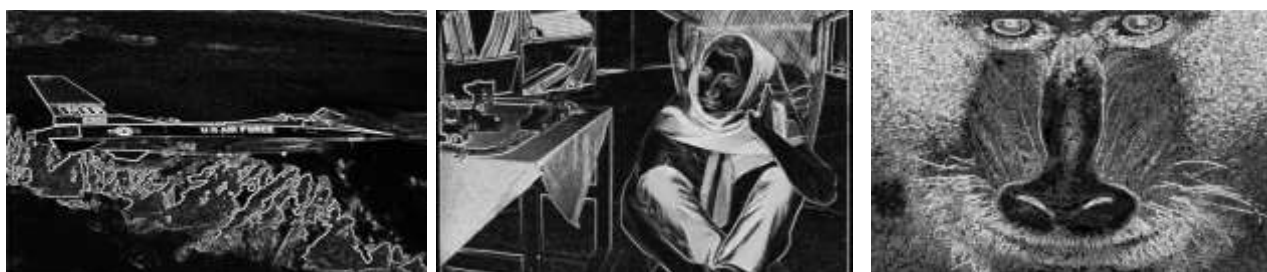
(c) 3X3 Absolute Sobel Edge Detection
